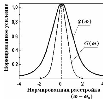
Рис. J.2. Вид нормированных АФХ: усиления среды (сплошная кривая) и усилителя с учётом его длины (пунктирная кривая)
